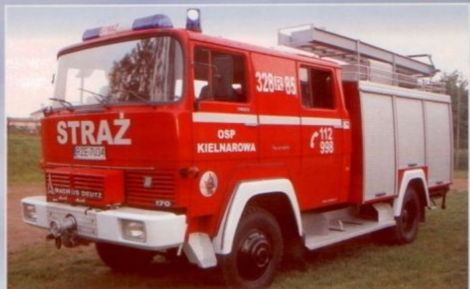
Samochód pożarniczy MAGIRUS DEUTZ FM 170 (1981), ze zbiornikiem na wodę, wyposażony w autopompę i motopompę
