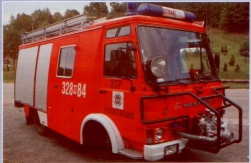
Samochód pożarniczy MAGIRUS DEUTZ 90M 66F (1982) ze zbiornikiem na wodę, autopompą i motopompą
