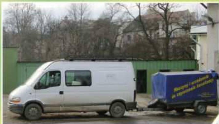
Samochód wraz z urządzeniem ciśnieniowym „Wuko”, służącym do przepychania zatorów kanalizacji
